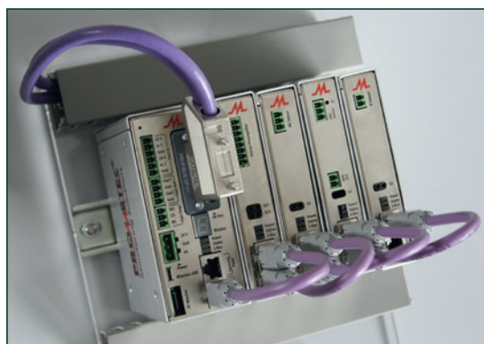
Bild oben: Unterschiedliche Module, montiert und verbunden auf einer Hutschiene – nicht nur technisch, sondern auch optisch modern und perfekt.
